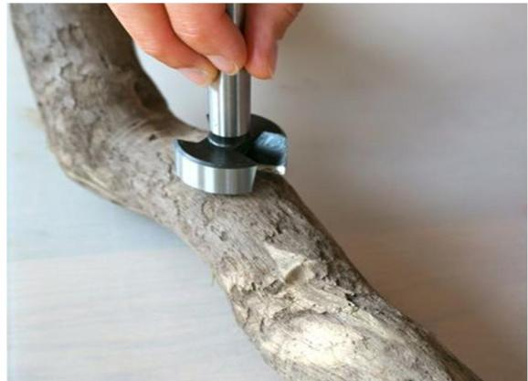
2. Den Forstnerbohrer in die Bohrmaschine einspannen. Bohrmaschine auf die kleinste Stufe einstellen und gewünschte Tiefe bohren. Dabei darauf achten, dass die Spitze des Bohrers das Holz berührt, da ansonsten der Bohrer nicht geführt wird.
