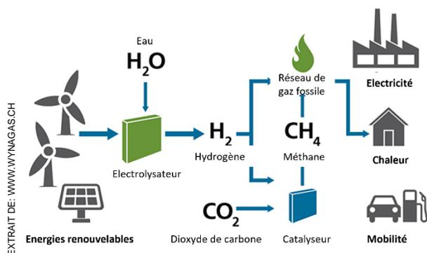
étape ultérieure<sup>40</sup>. Ce processus PtG peut aussi être combiné à la production de biogaz: lors de la méthanisation dite directe, le CO<sub>2</sub> contenu dans le biogaz réagit avec l'hydrogène et se transforme en méthane, ce qui permet de l'injecter dans le réseau de gaz avec le méthane contenu dans le gaz brut<sup>41</sup>.
